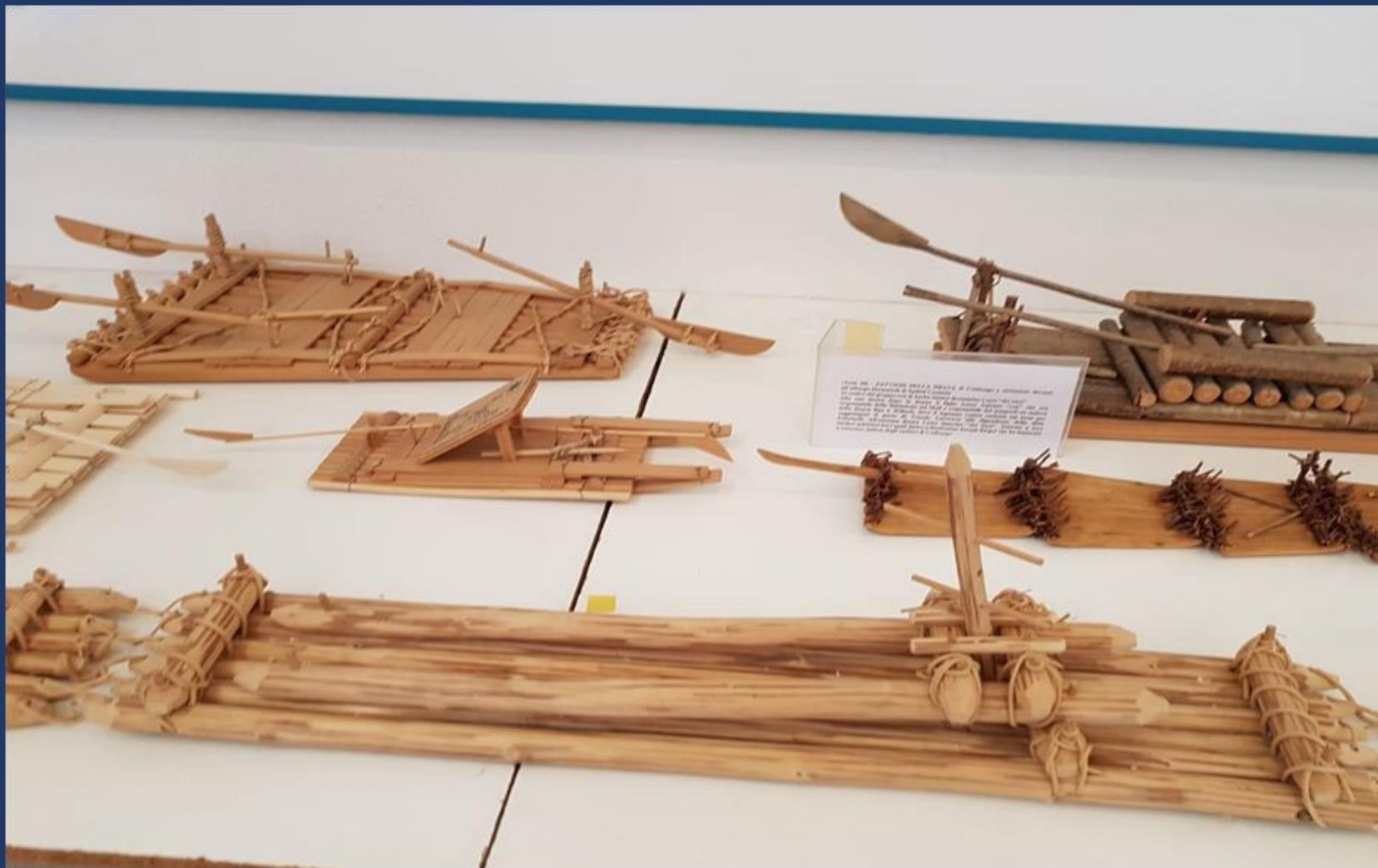
Modello ligneo in scala di una zattera con la posizione dell'equipaggio durante la navigazione. Si notano i lunghi remi utilizzati per la manovra a poppa e a prua della zattera.
