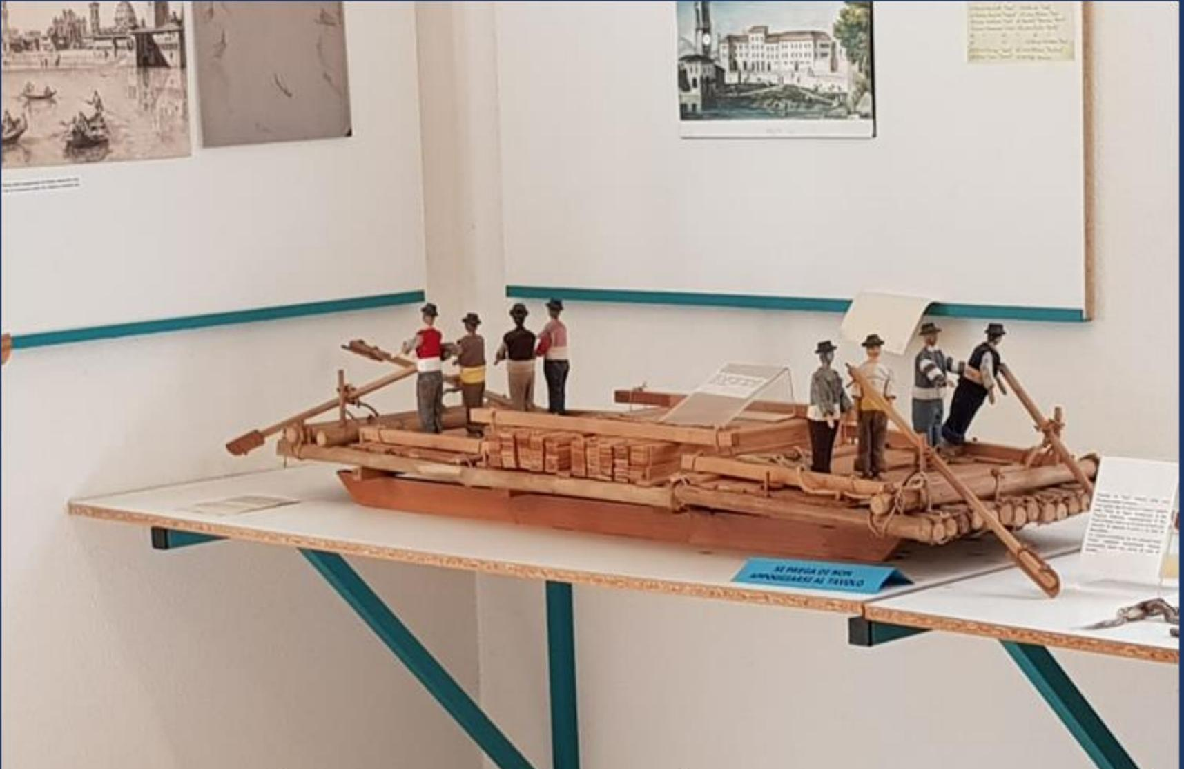
Modello ligneo in scala di una zattera pronta per il trasporto di merci provenienti dalle valli alpine( chiodi, carbone, pietre da mola ...). Visibili le ali mobili laterali usate per l'eventuale disincaglio della zattera con l'aiuto della corrente.
